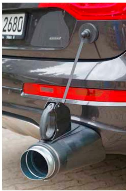
Universelle Abgastülle für die Erfassung der Abgase von Fahrzeugen, bei denen das Auspuffendrohr im Stoßfänger integriert ist.
