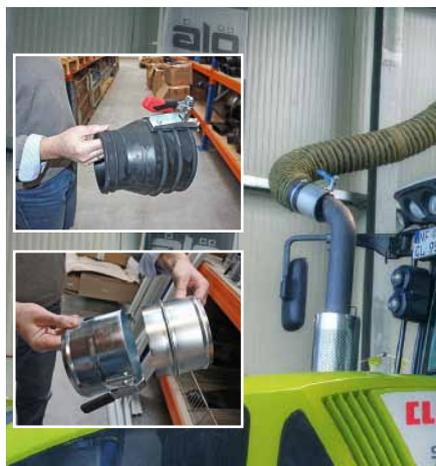
EXA bietet ein breites Sortiment von Abgasanzug-, -trichter oder -rohren. Die Anpassung an neue Endrohre findet im Haus statt.
