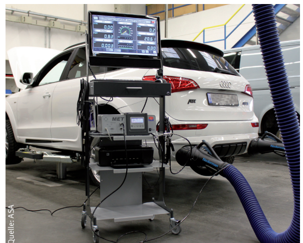
Bild rechts: Quelle ASA, Abgastülle mit Innenklemmvorrichtung bei der Abgasuntersuchung
